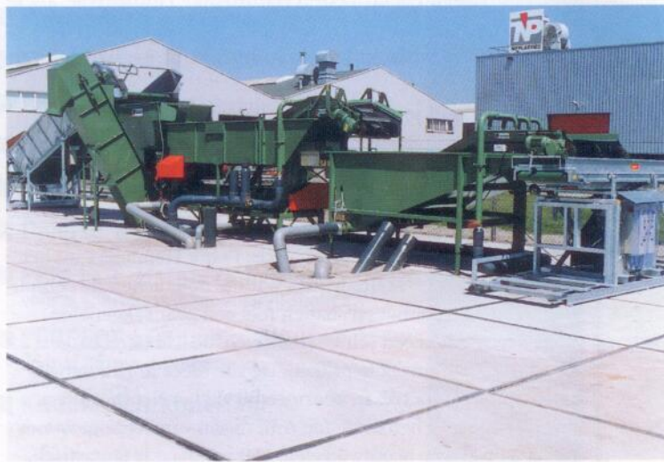
De nieuwe centrale spoelinstallatie voor de kwekerij waarmee in de loop van de komende week de eerste krokussen gespoeld zullen worden.
